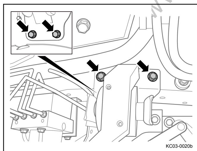
2. 安装并紧固发动机左隔振垫总成固定螺栓。
